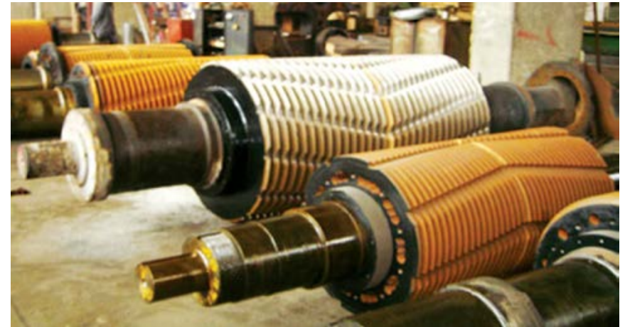
Lò che ép mía đường, khối lượng lên tới 26 tấn / Sugar cane pressing block, volume up to 26 tons
